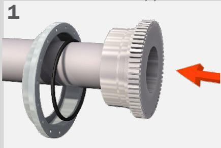
Установите на вал крышку полумуфты и уплотнительное кольцо, а затем насадите и ступицу полумуфты.
