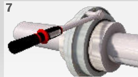
Соедините и закрепите крышки полумуфт (см. Таблицу с моментами затяжки болтов).
