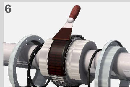
Нанесите смазку – Смажьте ступицы полумуфт под посадку уплотнительных колец.
