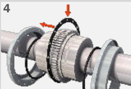
Закрепите валы агрегатов – установите картонную прокладку
